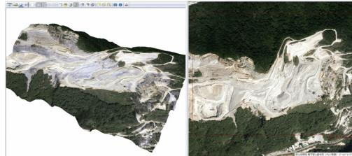
標高タイル（DEM5A/5B/10B）から3Dモデルを作成し、テクスチャに地理院地図を利用することが出来ます。また、点群データや測量計算データ／CADデータと重ねて高さの比較や観測計画／路線計画等に利用することができます。
