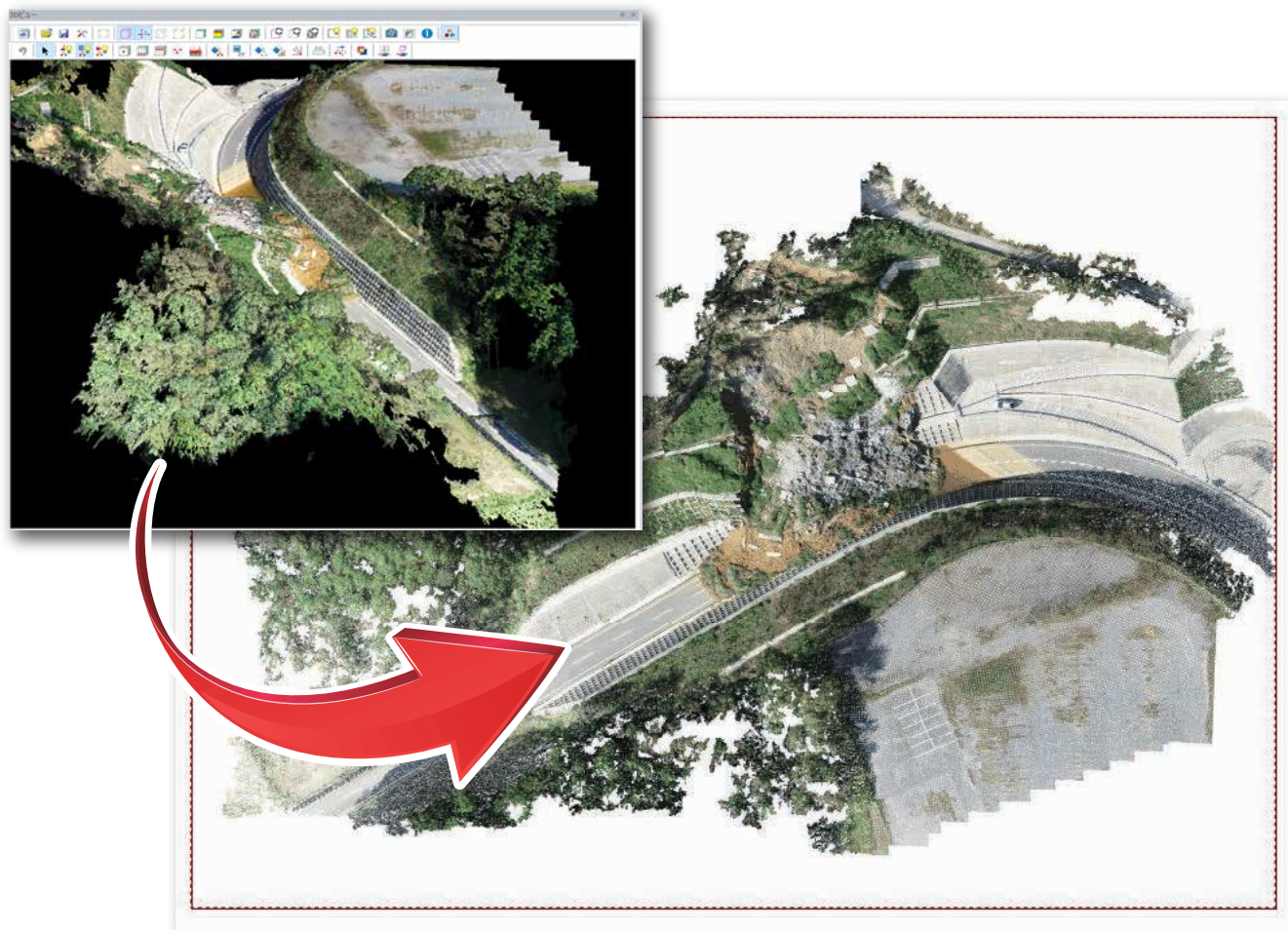
1クリックで点群からオルソ画像（点群平面画像）を作成。CADの背景図として利用ができます。
